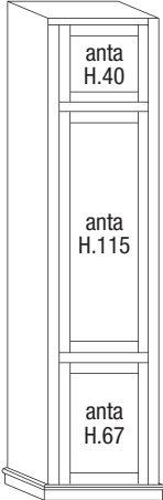
_colonna 1 vano _cm.57 x 38 H.241
